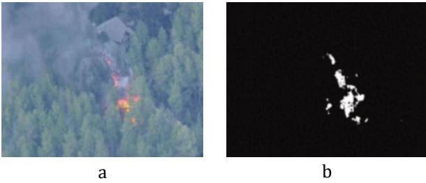
Şekil 8. Orman yangınlarının tespiti için yapılan segmentasyon çalışması (Yuan vd., 2015) (a: orijinal görüntü, b: threshold edilmiş görüntü).
