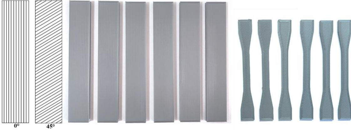
Şekil 1. Üretilen bulk PLA ve yapıştırma bağlantı numuneleri
