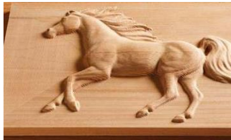
Şekil 3: 3 eksen CNC'de çalışılmış oyma örneği (Pinterest Inc., 2024, Carving With a CNC Router).
