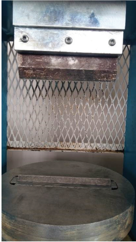
Şekil 2. Yapay süreksizlik elde etmede kullanılan düzenek.
