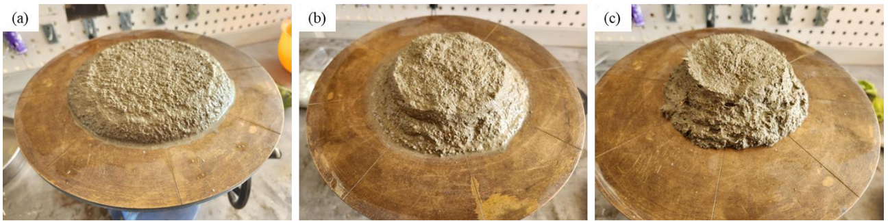
Şekil 4. TTCE katkılı harç örneklerin yayılma testi genel görünümü; (a) T0 kontrol harcı, (b) T3_0.50 harcı, (c) T12_0.75 harcı
