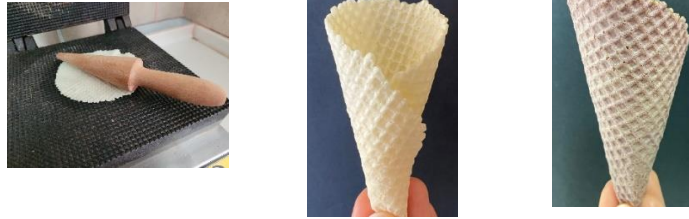
Şekil 2. Dondurma külâhı yapım işlemi ve üretilen glutensiz ve %10 GYU ikameli glutensiz dondurma külâhları (Ice cream cone making process and produced gluten-free and gluten-free ice cream cones with 10% rose petal flour)
