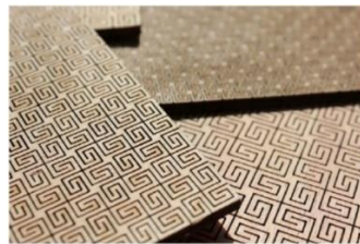
Şekil 8. Çift yönlü esnekliğe sahip kerf deseni (Zarrinmehr, ve ark., 2017)
