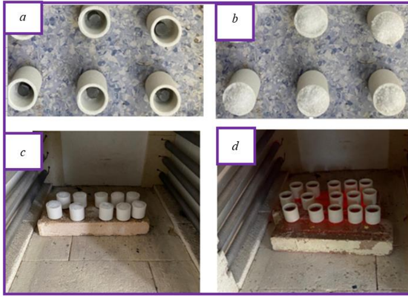
Şekil 2. Numunelerin Boro-Sinterleme süreci(Boro-Sintering process of samples) a) Numunelerin krozeğe yerleşimi(Placement of the samples in the crucible) b) Numunelerin bor tuzu ile üzerinin kapatılması (Covering the samples with the boron salt) c)Boro-Sinterleme öncesi (Before Boro-Sintering) d) Boro-Sinterleme sonrası (After Boro-Sintering)
