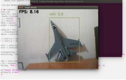
Şekil 8. Yolov3-tiny algoritmasından elde edilen çıktı (Output from the yolov3-tiny algorithm)
