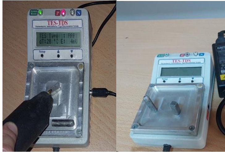
Şekil 1. N-P tip belirleme cihazı ve Numuneler (N-P type device and Samples)
