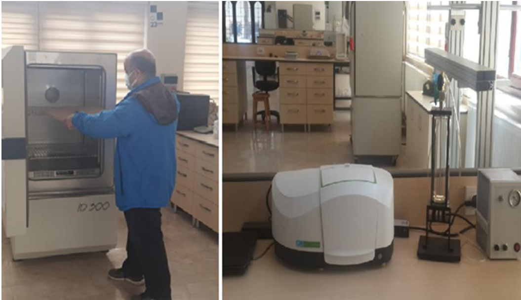
Şekil 1. Deney numunelerinin iklimlendirilmesi Nüve ID 300 ve gaz salınımının ölçüldüğü FTIR Spectrum Two cihazı (Acclimatisation of experimental samples Nüve ID 300 and FTIR Spectrum Two device for measuring gas release)
