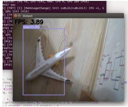
Şekil 13. Yolov8-m algoritmasından elde edilen çıktı (Output from the Yolov8-m algorithm)
