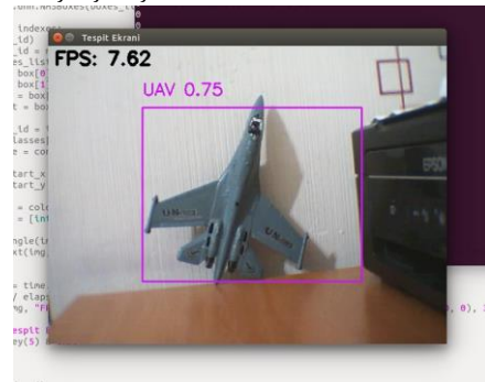
Şekil 9. Yolov4-tiny algoritmasından elde edilen çıktı (Output from the yolov4-tiny algorithm)
