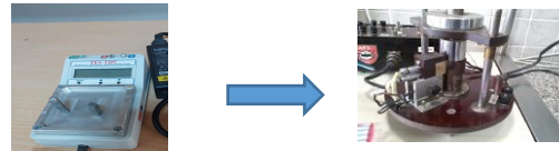
Şekil A: Bölge eritme ve pressleme yöntemi ile elde edilen numunelerin \alpha - \sigma ölçüm aleti ile parametreler tespit edildi / Figure A: The parameters of the samples obtained by zone melting and pressing method were determined with \alpha - \sigma measuring instrument.
