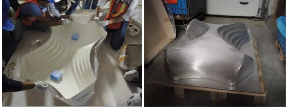
Şekil 34. Malzemenin kalıplanması işlemleri ( http://www.prosolve370e.com/home )
