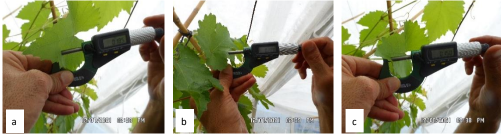
Şekil 11. Yaprak kalınlık ölçümü (a: sağ lob; b:orta lob; c:sol lob). Figure 11. Leaf thickness measurements (a: right lobe; b:middle lobe; c:left lobe).
