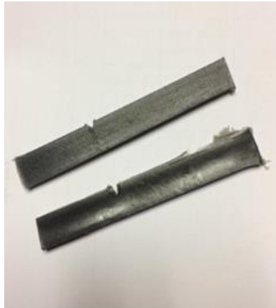
Fig. 7. Standard Izod test samples.
