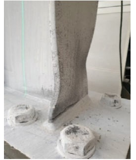
Şekil 3.15 - TB.1.19.L Kuvvet-Öteleme Açısı döngüsü ve flanş kesitinde kırılma (Ç.31).
