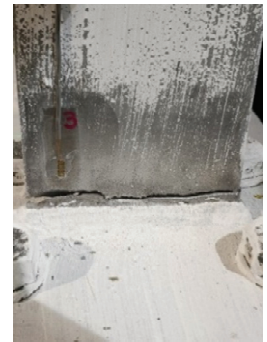
Şekil 3.10 - TB.1.14 Kuvvet-Öteleme Açısı döngüsü ve flanş kesitinde kırılma (Ç.28).
