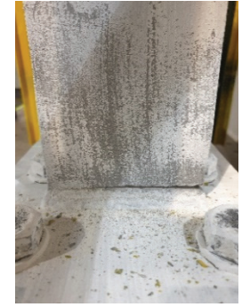
Şekil 3.9 - TB.1.9.L Kuvvet-Öteleme Açısı döngüsü ve flanş kaynağında kırılma (Ç.30).
