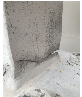
Şekil 3.19 - TB.1.27.L Kuvvet-Öteleme Açısı döngüsü ve flanş kaynağında kırılma (Ç.32).
