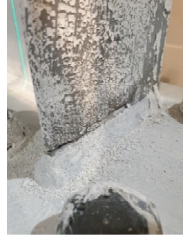
Şekil 3.18 - TB.1.26 Kuvvet-Öteleme Açısı döngüsü ve flanş kaynağında kırılma (Ç.29).
