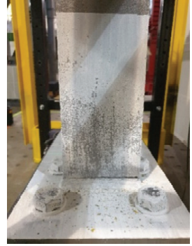
Şekil 3.20 - TB.1.28.L Kuvvet-Öteleme Açısı döngüsü ve flanş kaynağında kırılma (Ç.32).
