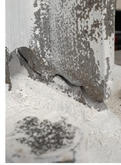
Şekil 3.12 - TB.1.16 Kuvvet-Öteleme Açısı döngüsü ve flanş kesitinde kırılma (Ç.30).
