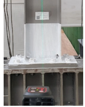
Şekil 3.21 - TB.1.29.L Kuvvet-Öteleme Açısı döngüsü ve flanş kaynağında kırılma (Ç.31).
