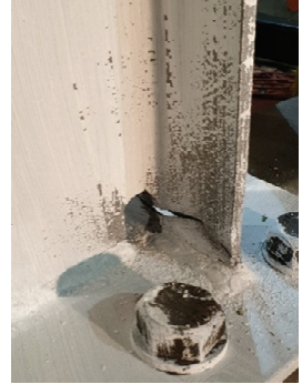
Şekil 3.6 - TB.1.3 Kuvvet-Öteleme Açısı döngüsü ve flanş kaynağında kırılma (Ç.27)
