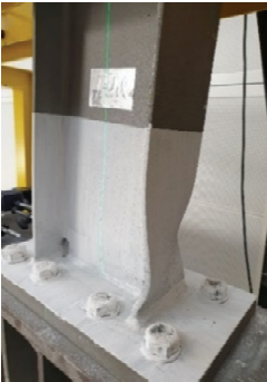
Şekil 3.7 - TB.1.7.L Kuvvet-Öteleme Açısı döngüsü ve flanş kaynağında kırılma (Ç.32).
