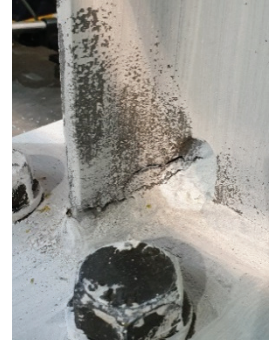
Şekil 3.8 - TB.1.8.L Kuvvet-Öteleme Açısı döngüsü ve flanş kaynağında kırılma (Ç.31).
