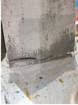
Şekil 3.21 - TB.1.29.L Kuvvet-Öteleme Açısı döngüsü ve flanş kaynağında kırılma (Ç.31).
