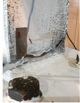
Şekil 3.5 - TB.1.2 Kuvvet-Öteleme Açısı döngüsü ve flanş kaynağında kırılma (Ç. 27)
