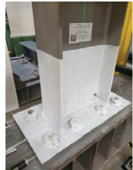
Şekil 3.7 - TB.1.7.L Kuvvet-Öteleme Açısı döngüsü ve flanş kaynağında kırılma (Ç.32).
