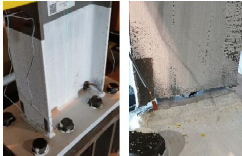
Şekil 3.4 - TB.1.1 çevrim sayısı 27, flanş kaynağında kırılma.
