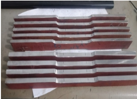
Şekil 2.7 - IPE270 S275JR kiriş gövde ve flanş için çekme numuneleri ile kaynak makro test numuneleri
