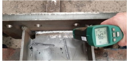
Şekil 2.6 - Kök paso sonrası temizlik ve pasolar arası sıcaklık ölçümleri.
