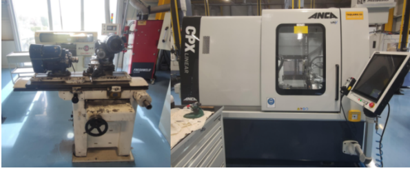
Şekil 7. Kuru Taşlama Tezgahtarının Islak Taşlama Tezgahtıyla Değişimi
