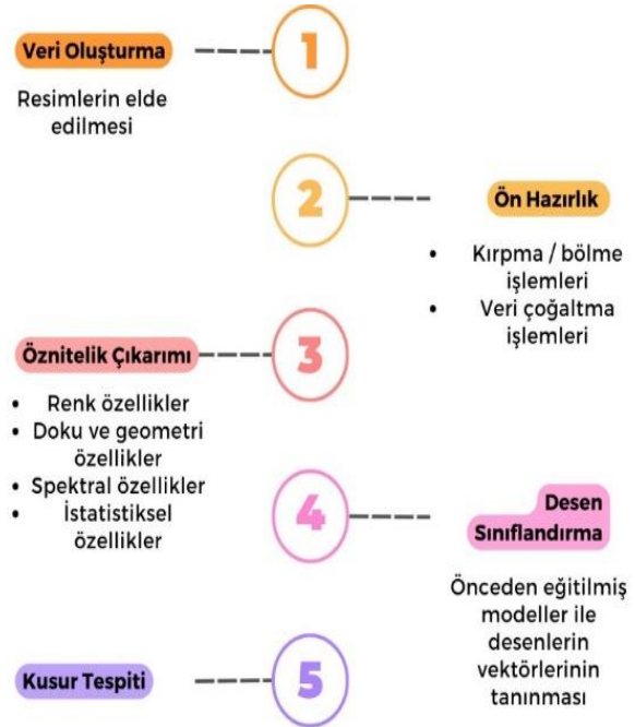
Şekil 2. Deri kusur tespitinde öznitelik çıkarımı ve desen sınıflandırma adımları
