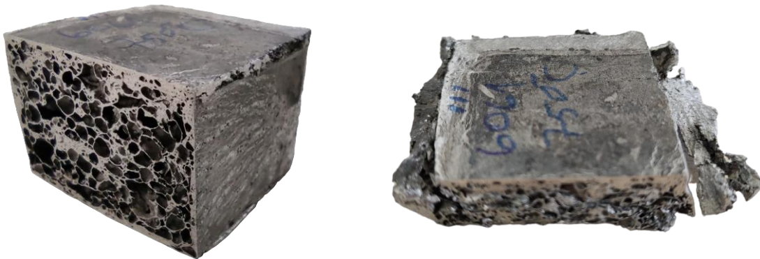
Figure 11. Physical condition of Al6061 before and after compression test (Al6061'in sıkıştırma testinden önceki ve sonraki fiziksel durumu)
