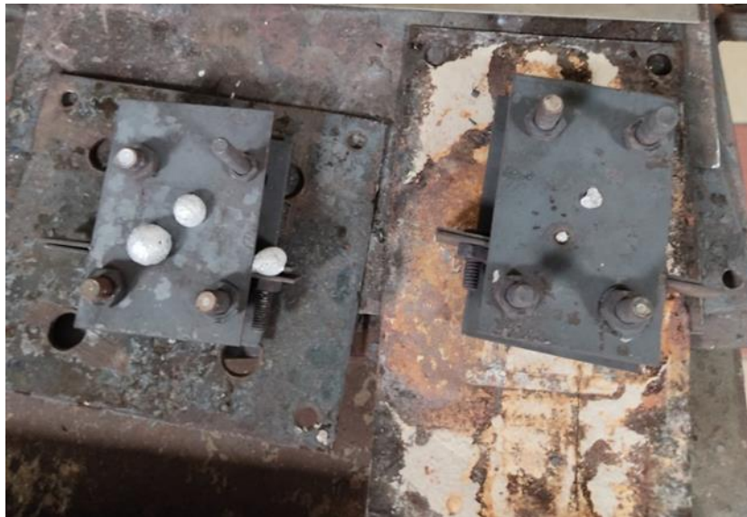
Figure 5. Foaming in closed mold (Kapalı kalıpta köpürme)
