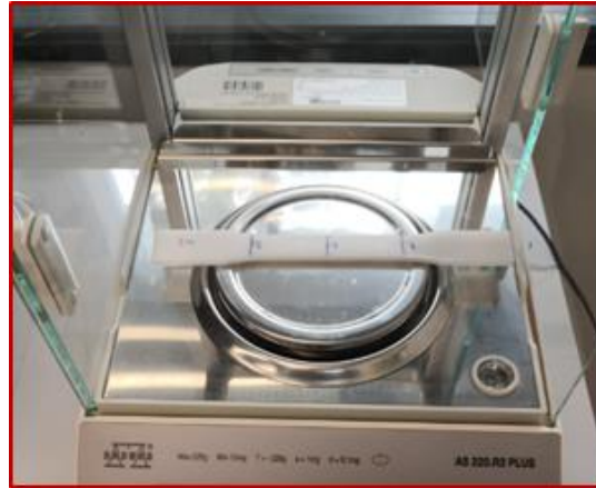
Şekil 5. Numunelerin ağırlık ölçümü (The weight measurement of the samples)
