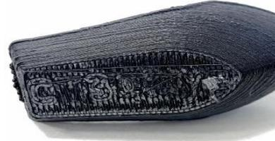
Şekil 7. Destek nedeniyle alt yüzeyin pürüzlülüğü
