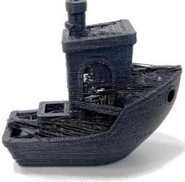
Şekil 4. Sızıntı ve İplikler
