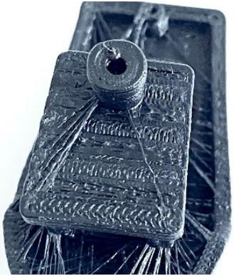
Şekil 5. Üst Yüzeyde Çizikler
