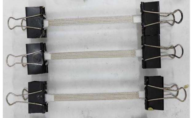
Şekil 10. Çekme test numuneleri.
