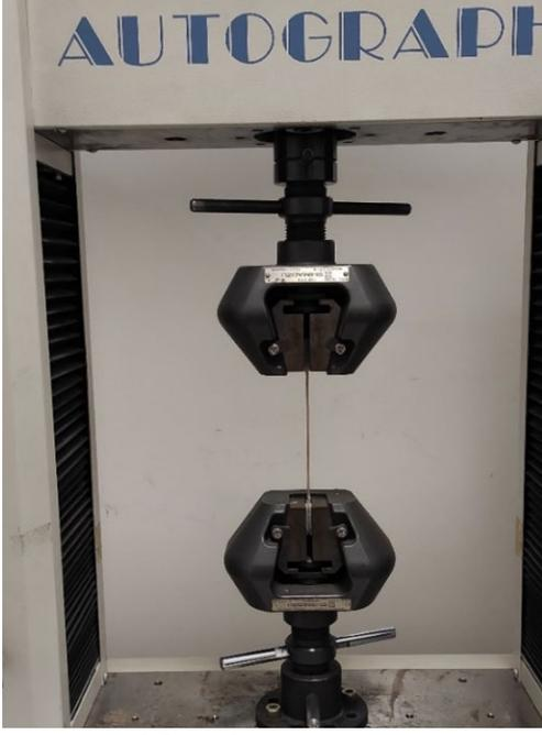
Şekil 11. Çekme test cihazı.
