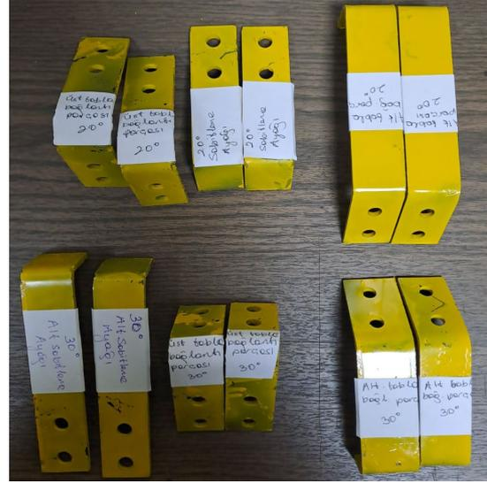
Şekil 5. Pompa yataklama sistemi açılı bükümlü saçlar.
