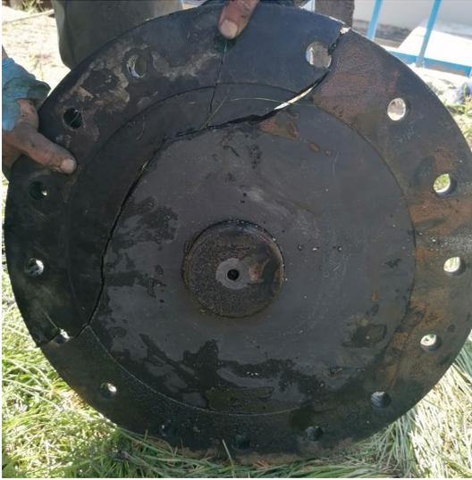
Şekil 2. Arşimet pompanın yataklama probleminden dolayı kırılan alt yatak flanşı.
