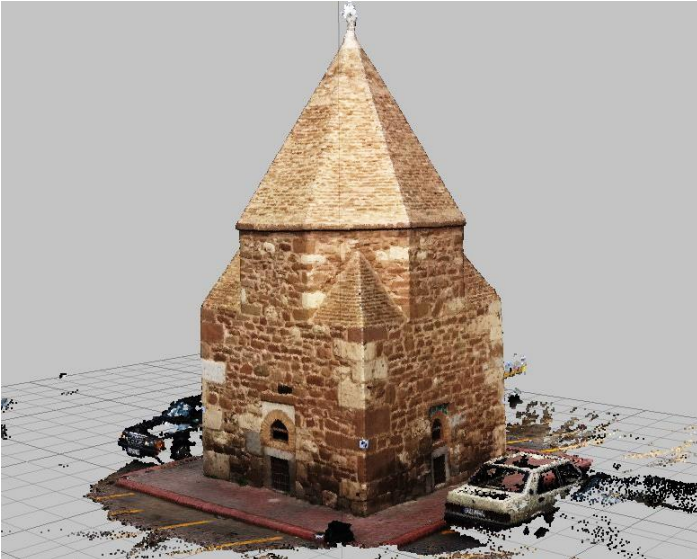
Şekil 6. HD (720p), 80 Fotoğraf, Yoğun Nokta Bulutu, 1.043.591 Nokta
