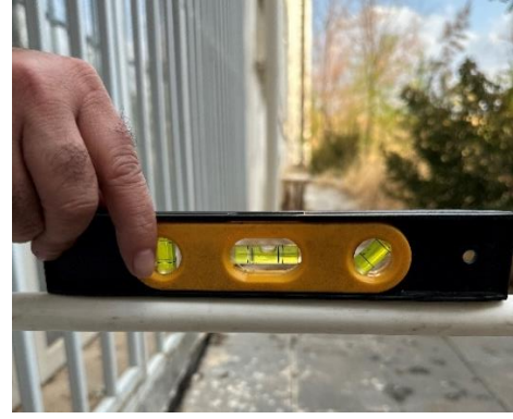
Şekil 3 Deney düzeneğinin yatay dengeye alınması
