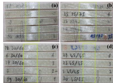
Şekil 6. Eğilme testi sonucu hasara uğrayan numuneler
