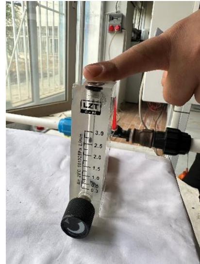
Şekil 4 Hava debimetresi ile ölçüm
