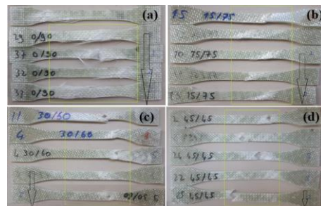
Şekil 5. Çekme testi sonucu hasara uğrayan numuneler
