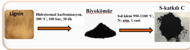
Şekil A: Kendinden kükürt katkılı karbonların sentez basamakları / Figure A: Synthesis steps of self-sulfur doped carbons
