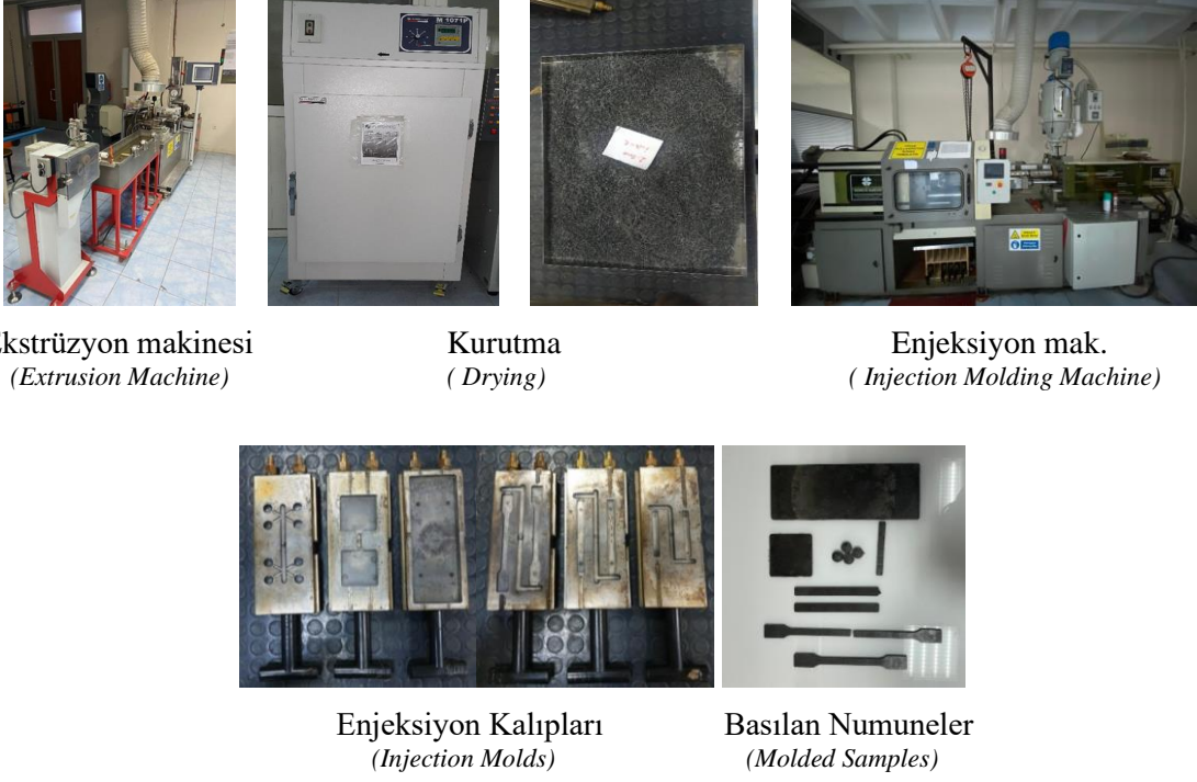
Şekil 2. LDPE/Fe polimer kompozitinin numune hazırlama aşamaları (Sample Preparation Stages of LDPE/Fe Polymer Composite)
