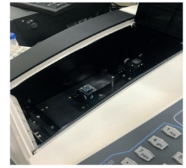
Şekil 31. Spektrofotometrik okuma için viyallerdeki numunelerin spektrofotometreye yerleştirilmesi.
