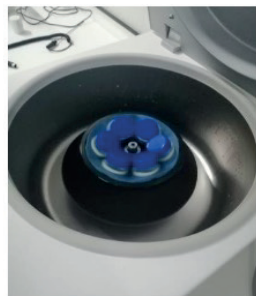
Şekil 41. Numunelerin santrifüj cihazına yerleştirilmesi
