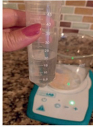
Şekil 22. Limon kabuğu tozunun etil alkolle karıştırılıp, fenol tayini için hazırlanması.
