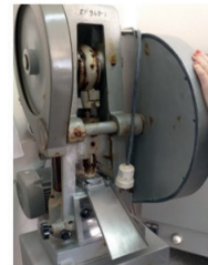
Şekil 17. Manuel ilaç makinesinde tabletin basılması.
