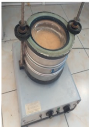
Şekil 7. Limon kabuklarının titreşimli elekten geçirilmesi.
