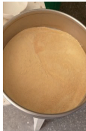
Şekil 8. Eleme işlemi sonrası 35 mesh boyutuna getirilen limon kabuğu tozu.
