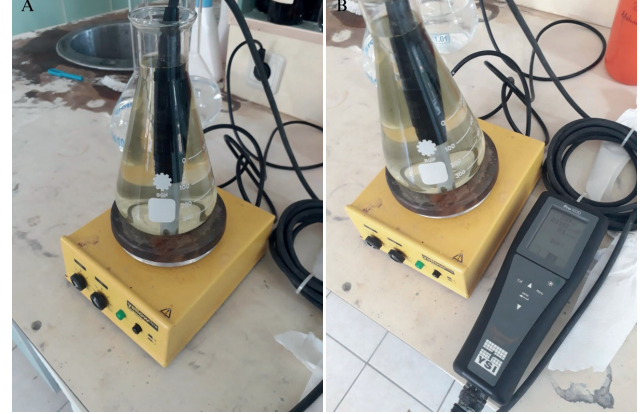
Şekil 5. A. Çözelti karışımı B. İletkenlik ölçümü
