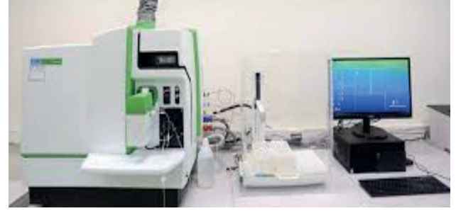
Şekil 37. Mineral miktar tayininde kullanılan ICP-MS cihazı (BUTAL).
