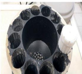
Şekil 34. Mikrodalgada numunelerin yakıldığı kartuş.
