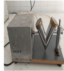
Şekil 11. Limon kabukları ve kimyasalların V tipi karıştırıcıda karıştırılması.
