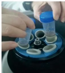
Şekil 24. Numunelerin santrifüj cihazına yerleştirilmesi
