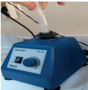
Şekil 40. Vorteks cihazında numunelerin homojenize edilmesi
