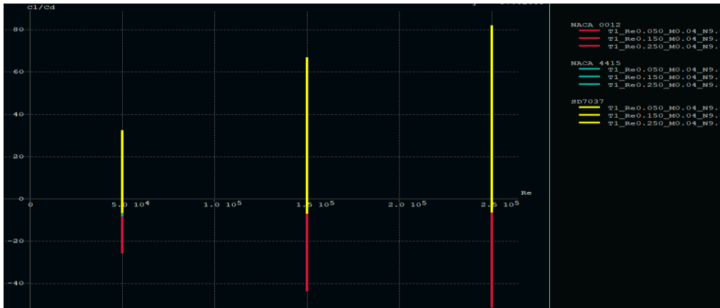
Şekil 2: XFLR5 programında kanatların üç farklı Reynolds sayısındaki C_L/C_D değerleri.
