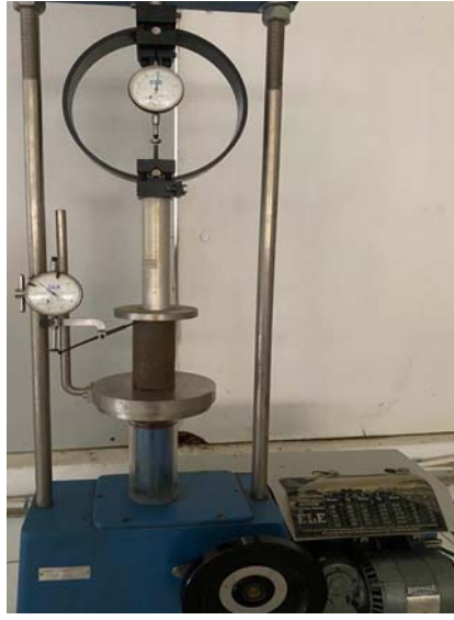
Şekil 5. Serbest basınç aleti ve kil numunesi
