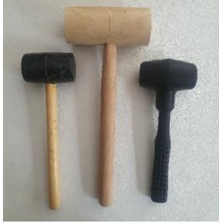
Şekil 16. Doku Yumuşatmasında Kullanılan Ahşap ve Plastik Tokmaklar (Yasemin Koparan Kişisel Fotoğraf Arşivi, 2022)
