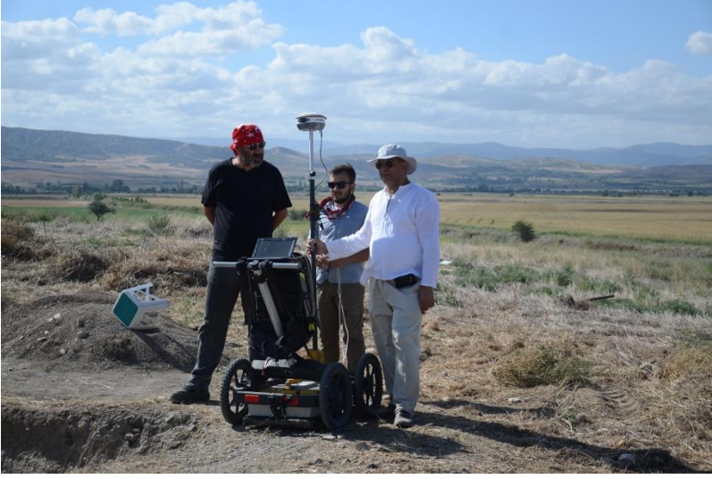
Resim 2. Amasya İli, Oluz Höyük H18 ve H19 Plankarelerinde GPR Ölçümü.
