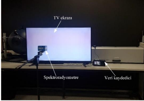
Şekil 4. Renk gamı ölçüm düzeneği.
