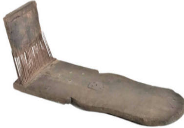
Görsel 13: Osmanlı ahşap çelik döğme çivili tarak, 58x15cm. ( Osmanlı Ahşap Çelik Döğme Çivili Tarak Halı Dokumada Kullanılan Yün İp Yapımında Kullanılan Çivili Yün Tarağı | Garaj Antik , n.d.)
