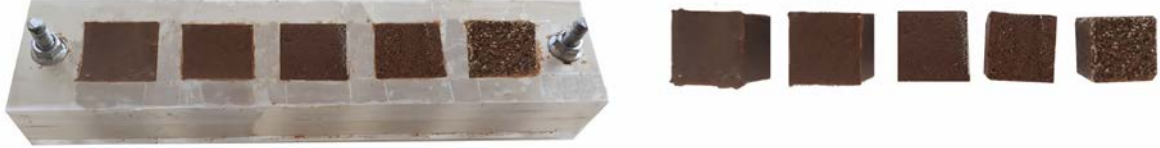
Şekil 3. Deney çalışmalarında kullanılan kalıbın ve kompozit numunelerin fotoğrafları.
