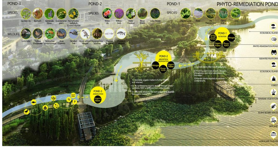
Şekil 5. Fitoremediasyon sistemi (ASLA, 2021).
