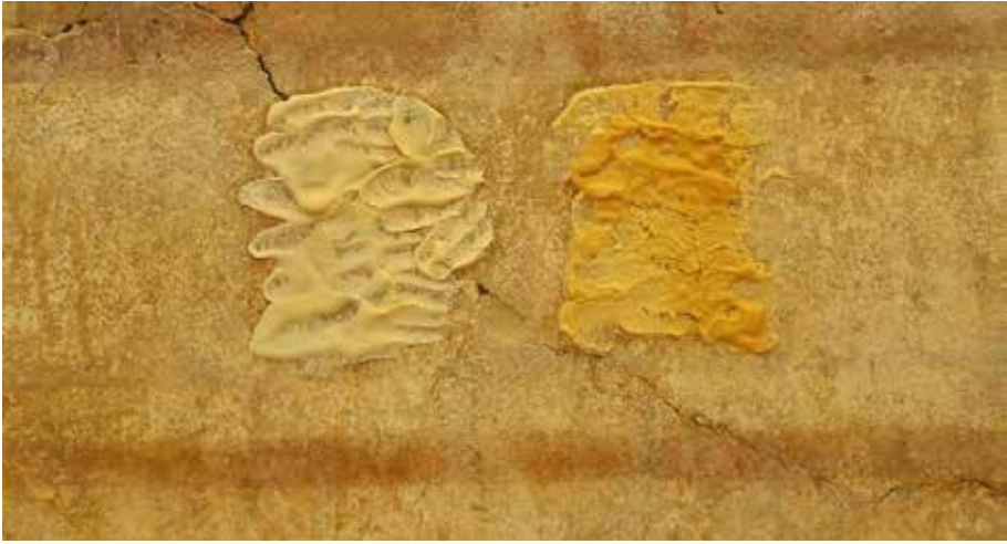
Görsel 3: Efes Yamaçevler 2’de iyonik reçinelerle (anyon ve katyon) yapılan temizlik uygulaması (soldaki anyon, sağdaki katyon uygulaması) (Ceren Gürçay Yılmaz Kişisel Arşivi)
