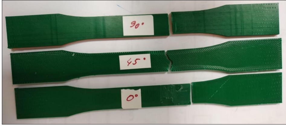
Şekil 6. Tam dolu numunelerde kırılma şekilleri.
