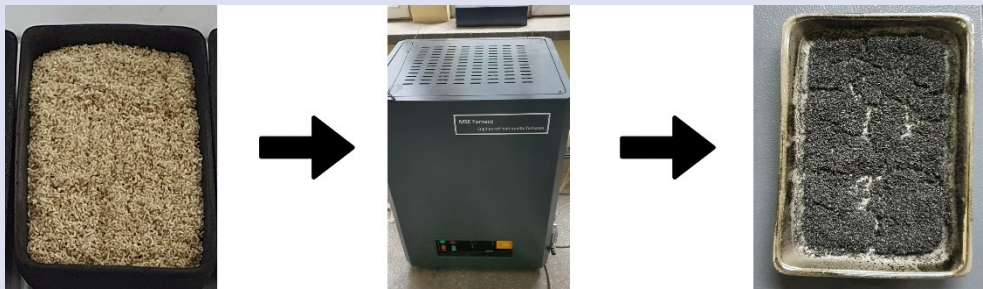
Resim 2. Piroliz işleminde kullanılan tüp fırın ve kavak talaşı biyokömürü Figure 2. Tube furnace used in pyrolysis process and poplar sawdust biochar
