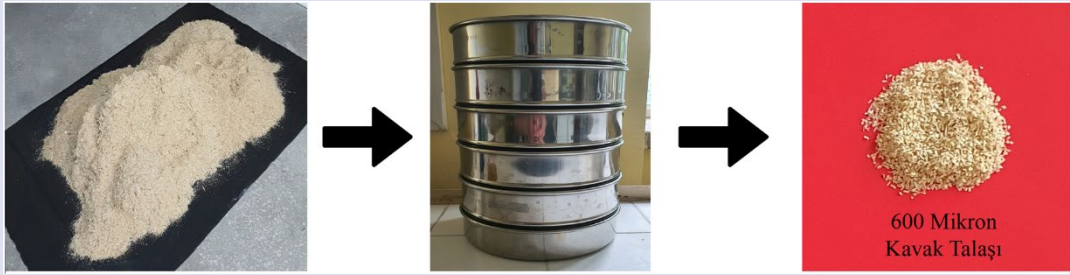
Resim 1. Kavak talaşı 600 µm boyutuna kadar elenmiştir. Figure 1. Poplar sawdust sieved to a size of 600 µm.
