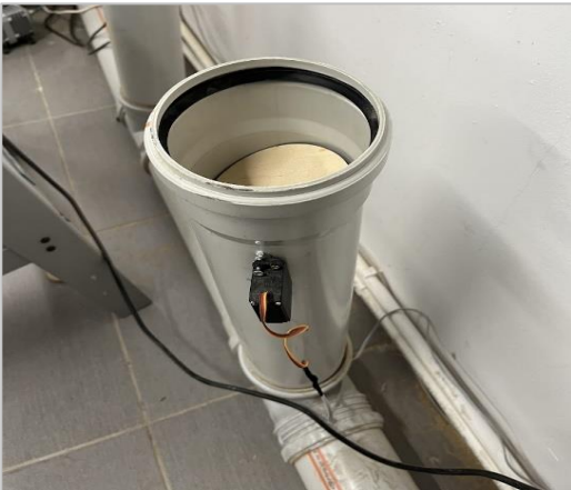
Şekil 8. İstasyon klapa bağlantısı
