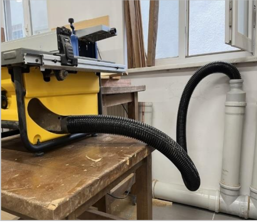
Şekil 7. Makina spiral hortum bağlantısı
