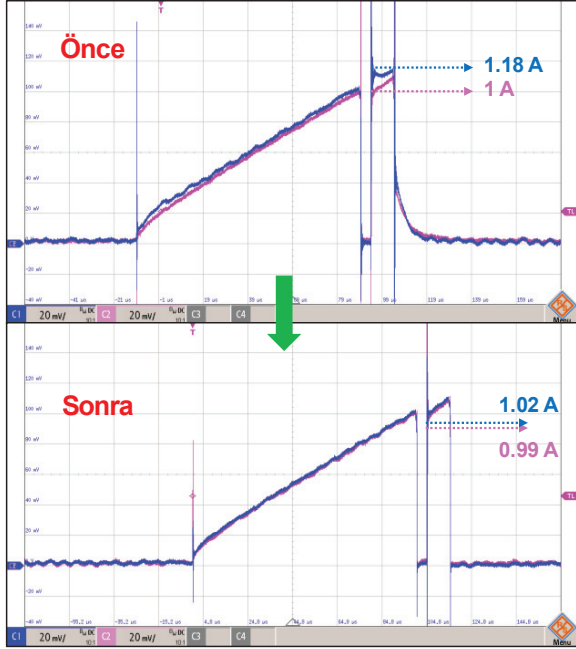
Şekil 22: Önerilen algoritma ile akım paylaşımının değişimi
