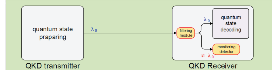
Şekil 9-11 Güç Ölçerle Saldırıdan Korunma Yöntemi[199]
