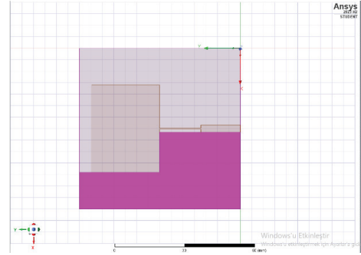
Şekil 5: Dikdörtgen yamalı çeyrek dalga dönüştürücü MY antenin L şekilli toprak yüzeyi.
