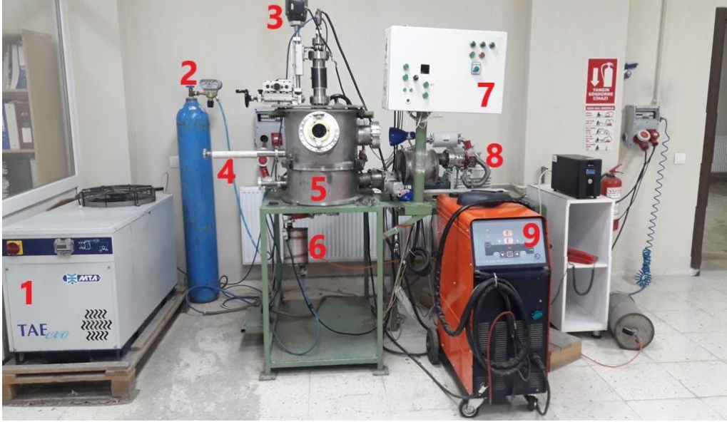
Şekil 3. Vakum ark ocağı ünitesi (1; Soğutma ünitesi, 2; Argon gazı, 3; X ve Y eksenlerinde hareketi sağlayan köruk, 4; Manipülâtör kol, 5; Ark ocağı haznesi, 6; Pnömatik emiş vanası, 7; Kontrol panosu, 8; Rotary vakum pompası ve turbo moleküler pompa, 9; Ark güç kaynağı)
