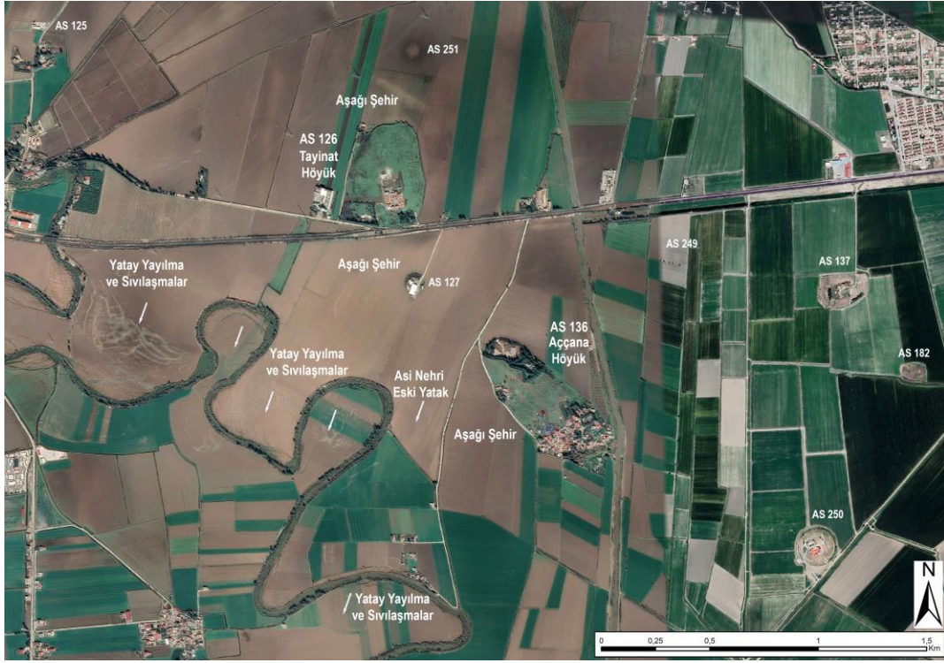
Fig. 2: 6 Şubat Kahramanmaraş merkezli depremler sonrası Maxar uydu görüntüsünde Asi Nehri'nin yatağı çevresinde görülen yatay yayılma ve sıvılaşma izleri (Hazırlayan M. Akar).
