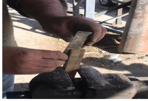
Fotoğraf 17. Baş kısmının sap kısmına yerleştirilmesi (Kılıç Karatay, 2023)
