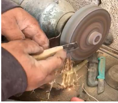
Fotoğraf 26. Ağız kısmının keskinleştirilmesi (Kılıç Karatay, 2023)
