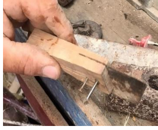
Fotoğraf 24. Kesilen metal baş kısmının sapa kadak çivileri ile sabitlenmesi (Kılıç Karatay, 2023)
