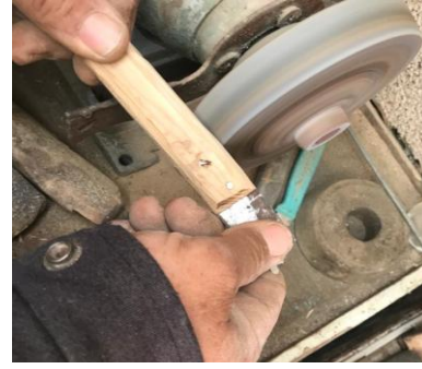
Fotoğraf 27. Sap kısmının şekillendirilmesi (Kılıç Karatay, 2023)
