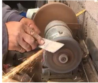
Fotoğraf 23. Metal parçanın kesilmesi (Kılıç Karatay, 2023)
