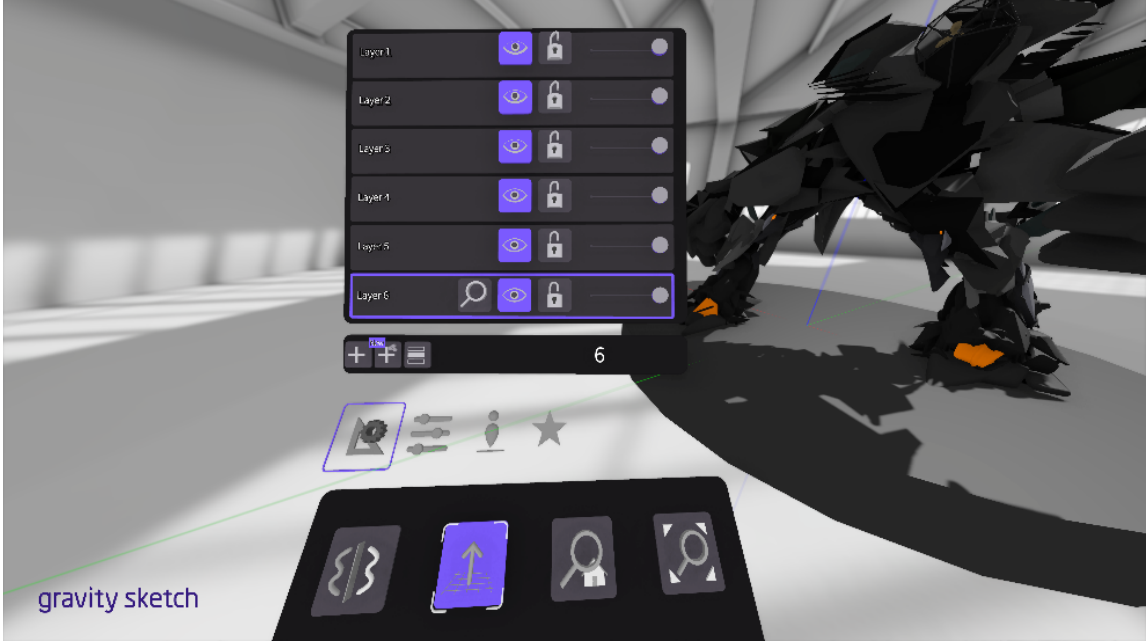
Görsel 19. Gravity Sketch yazılımında tasarlanan karakterin, layer paneliyle organize edilme yöntemini gösteren arayüz imajı (Kişisel arşiv, 2024)
