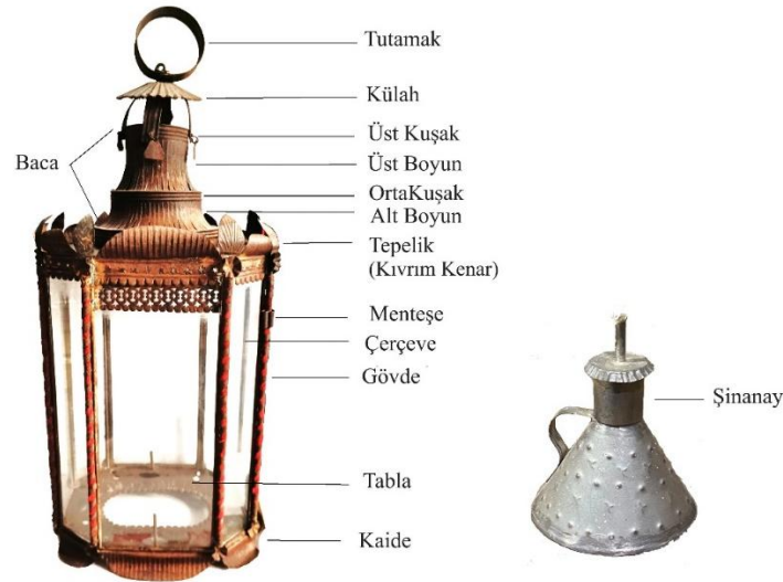
Görsel 10: Dursun Turacı'nın Tokat Şehir Müzesi Envanterinde Bulunan Çizimine Göre Fenerin Bölümleri
