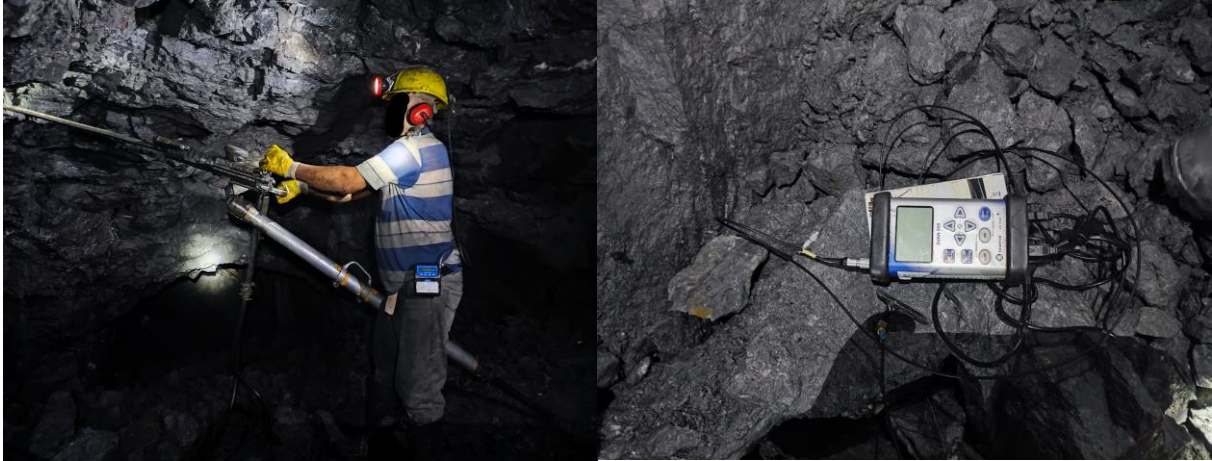
Şekil 2. Titreşim ölçümü için kullanılan SVANTEK Svan 958 marka titreşim ölçüm cihazı ve cihazın kullanımı
