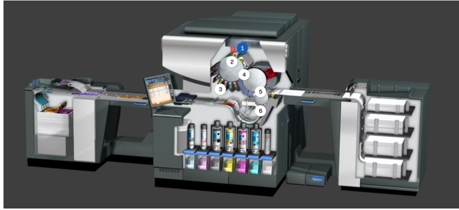
Görsel 6. HP Indigo Baskı Makinesi.
