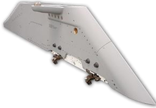
Şekil 6. F-35 Hava Yer Yük Pylon'u [11]
