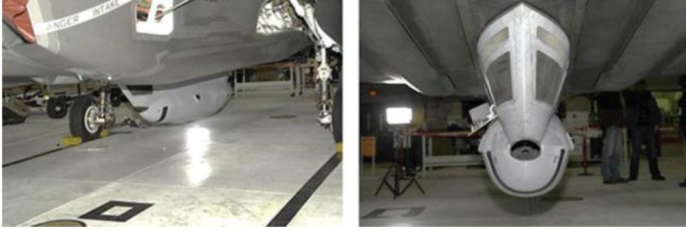
Şekil 13. F-35 Top Sistemi Pod Yerleşimi [4]
