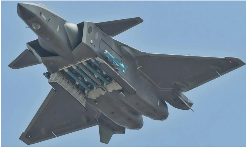
Şekil 3. Dahili Silah Yuvası Yan Yana Yerleşim Örneği [8]
