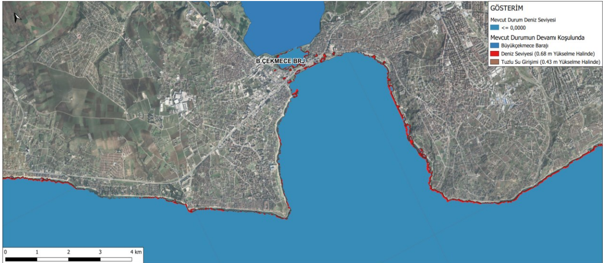
Şekil 8. Marmara Denizi seviyesinin 2053 yılında yükselmesi halinde Büyükçekmece Barajı'nın güneyinde sular altında kalması muhtemel bölgeler ve tuzlu su girişimi yaşanma ihtimali olan bölgeler (İSKİ, 2022)
