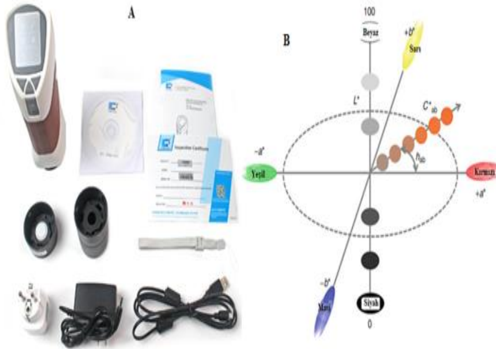
Şekil 1. Renk ölçüm cihazı (A) ve CIELAB renk uzayının şematik gösterimi (Cheung, 2016) (B)
