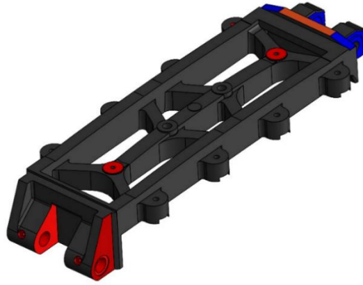
Şekil 2. Model-2 kalıp maşa tasarım geometrisi
