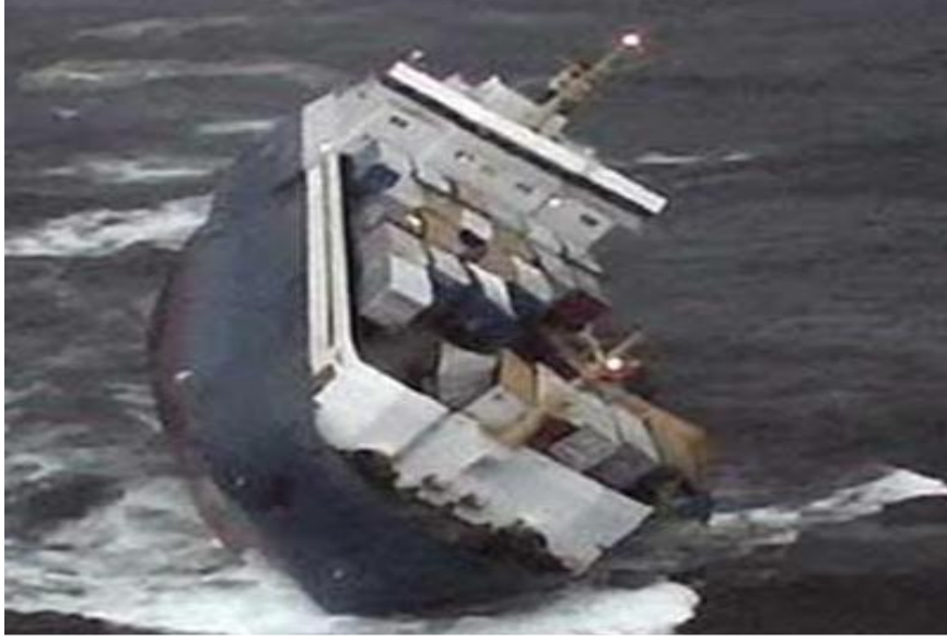
Resim 1. Yanlıř yükleme nedeniyle stabilitesi bozulmuş bir gemi (UNECE, 2014).
