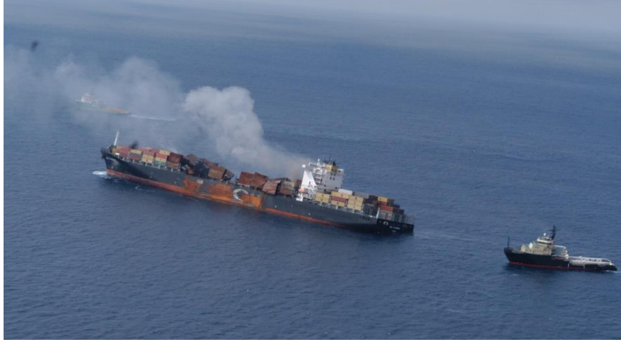
Resim 6. Yükleme hatası nedeniyle, stabilitesi bozulan konteyner gemisi deniz kazası (Wingrove, 2024).
