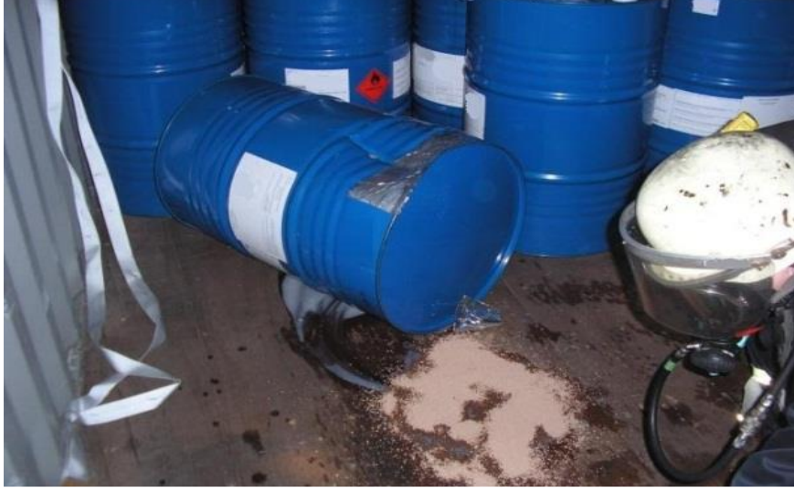
Resim 3. Sabitlenmemiř varillerden dökülen tehlikeli maddeler (UNECE, 2014).
