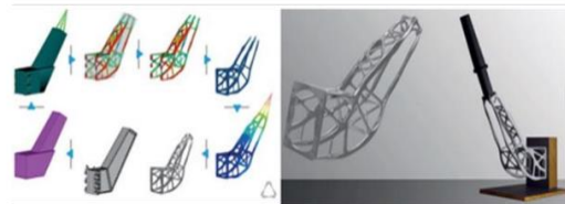
Şekil 4. Sentinel-1A ve Sentinel-1B uydularının anten braketinin TO süreci [12] (Topology Optimization Process of the Antenna Bracket for Sentinel-1A and Sentinel-1B Satellites)
