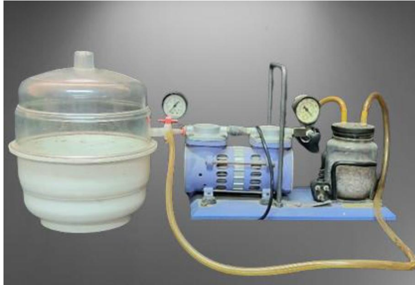
Şekil 4. Laboratuvar ölçekli vakumlu emdirme sistemi (Vinod ve ark., 2024).
