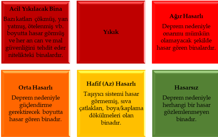
Şekil 3. Hasar tespitinde gözlemsel olarak dikkat edilen hususlar (İzmir Valiliği İl Afet ve Acil Durum Müdürlüğü, 2020'den yararlanılarak Yazar Görgülü tarafından oluşturulmuştur, 2023)
