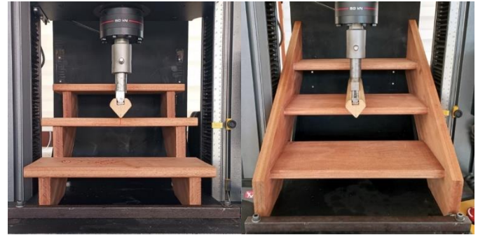
Şekil 8. Tip I (Seren üzerine bindirme basamaklı) ve Tip II (Serene gömme basamaklı) merdivenin test düzeneğindeki konumları
