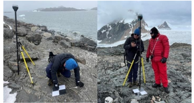
Şekil 5. Uçuş bölgesinde yer kontrol noktalarının işaretçilerinin yerleştirilmesi ve RTK ölçmeleri
