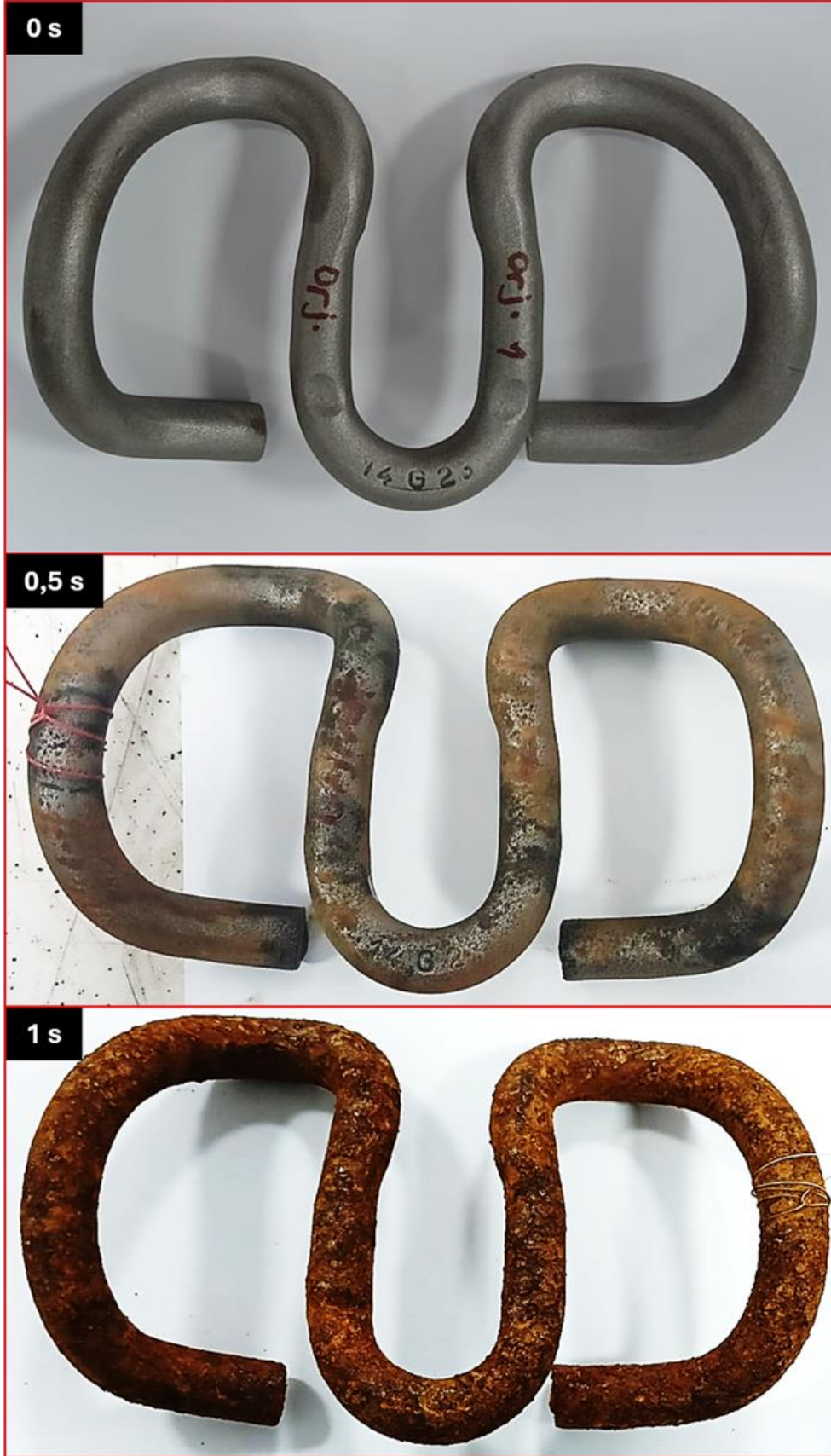
Şekil 5. Gergi kıskacında yüzey korozyonunun saatlik gelişim aşamaları
