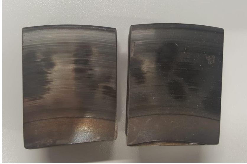
Şekil 4. Dinamometre testleri sonrası lekeli diskten alınan numuneler
